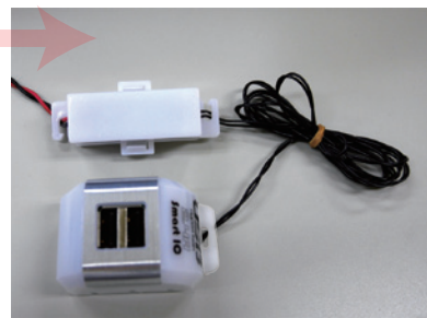
ヒューズ BOX にLEDトップを接続し完成です。
