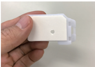
ベース板裏の両面テープを剥がします。
