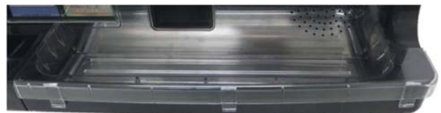
②筐体下皿の下に両面テープで固定します。
