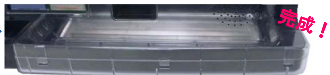
②筐体下皿の下に両面テープで固定します。
