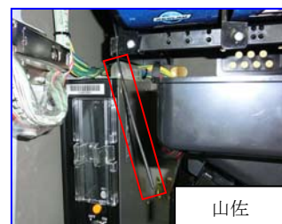
受信専用アンテナ取付例
