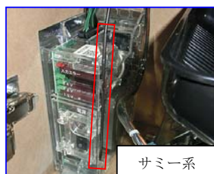
受信専用アンテナ取付例
